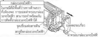
รูปที่ 3: วิธีการเดินสายเชื่อมต่อสัญญาณ
