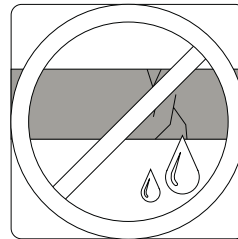
ตรวจสอบท่อระบายน้ำ ว่ามีแตกรั่วเสียหายหรือไม่
