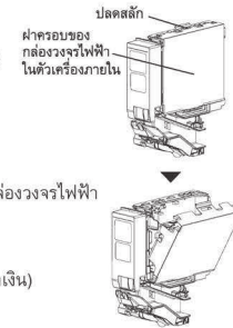
รูปที่ 1: การถอดฝาครอบออกจากกล่องวงจรไฟฟ้าในตัวเครื่องภายใน
