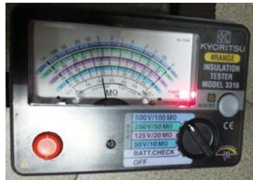
การวัดโดยใช้เมกะโอมห์วัดค่าความเป็นฉนวนของขดลวดคอมเพรสเซอร์
