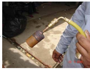
2 ต่อหัวส่งแรงดันเข้ากับสายเรกกูเลเตอร์
