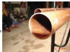
8 ตรวจสอบเช็คความสะอาดถ้าไม่สะอาดให้ล้างใหม่ไปเรื่อยๆ
