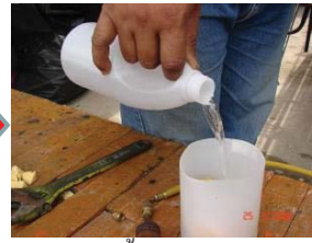
3 เทน้ำยาอะซิโตนลงในภาชนะที่มีฟองน้ำอยู่
